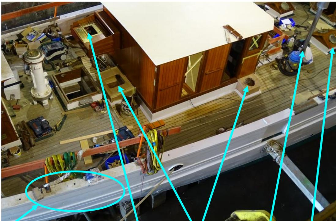
Remplacement de la préceinte - pupitre machine - hiloires - conduit de chaudière - lenk sur hiloires
