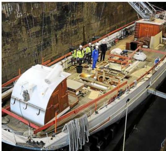
Afin d'effectuer les travaux en salle des machines, une brèche a été réalisée sur le pont de la goélette.
