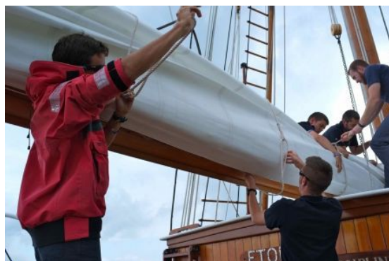
Ensuite la voile est rabantée, soit attachée à l'aide de rabans le long du gui. Photo David Ladent. Marine nationale
