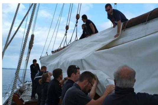
Lorsque la voile est affalée, tout le monde se met en ligne pour rouler proprement la voile. Photo David Ladent. Marine nationale
