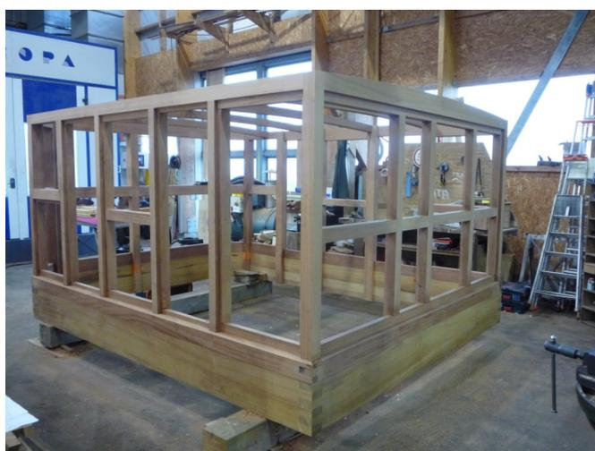
Le nouveau roof passerelle en cours de fabrication (Photo B. Potin)
