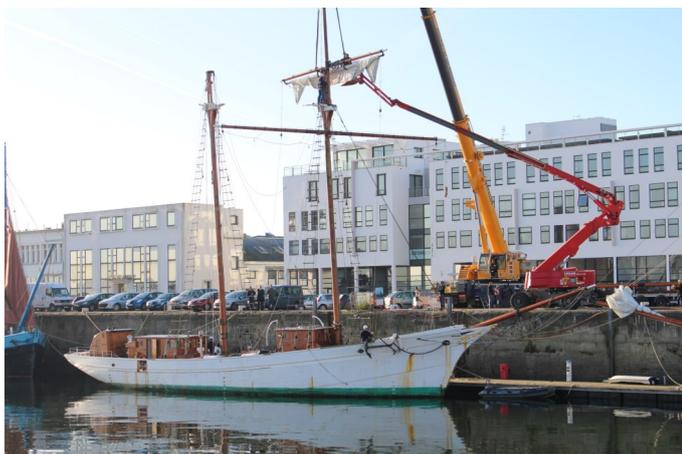
Le démontage des mâts avant de rejoindre la base sous-marine
