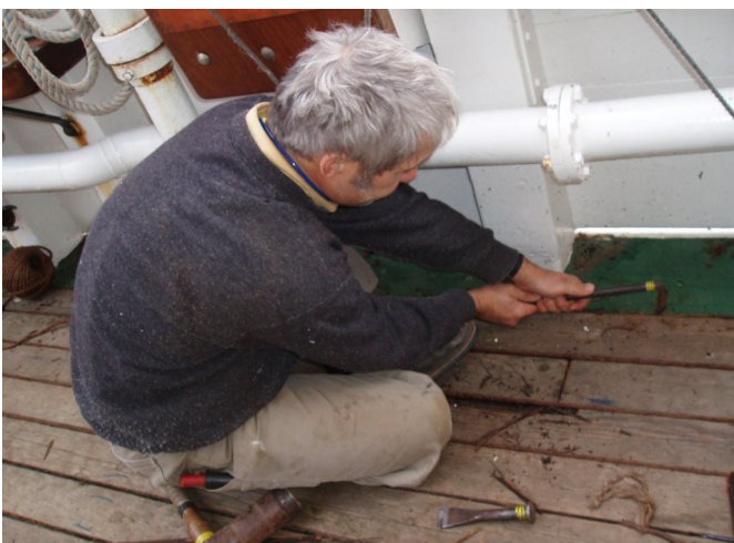
Le charpentier retire le brai avec son « Bec de corbin »
