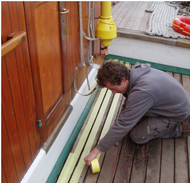
Protection avant le coulage du brai
